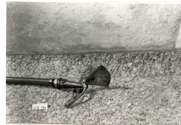
Brise-jet en laiton (raccord de tuyau) (Vin 506) Wasserstrahlregler aus Messing (Sprinkler)
