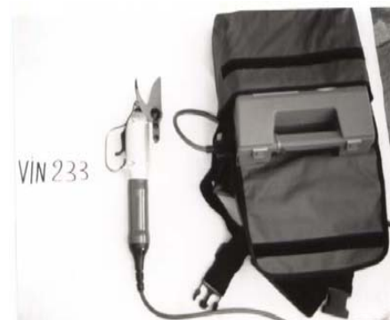
sécateur pneumatique (Vin 233) Pneumatische Rebschere
