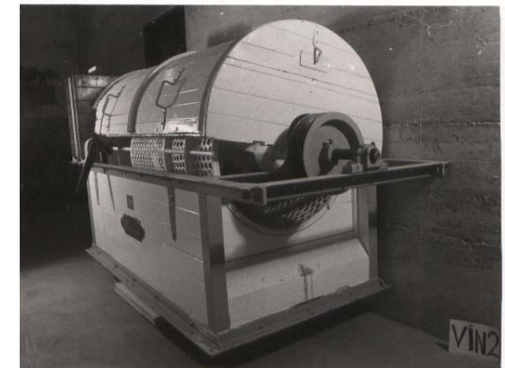
Egrappeuse (motorisée) (Vin 2) Entbeermaschine (mit Motor)
