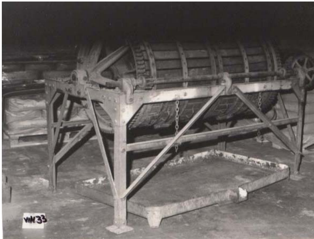
Pressoir horizontal à moteur (Vin 33) Horizontale Presse mit Motor
