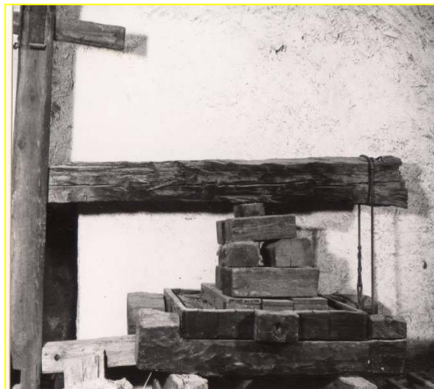
Pressoir à levier et à corde Chv 24) Baumkelter mit Hebelbaum
