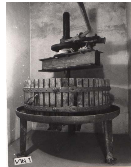
Pressoir à vis centrale (Vin 1) Kelter mit stehender Metallspindel
